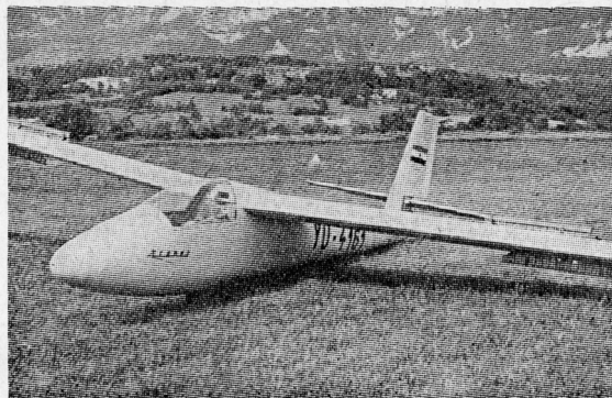
Nový juhoslovanský klubový vetroň Trener: celodrevená konštrukcia, profil Wortman EX 18 %, plávajúca výškovka. Dĺžka 6,9 m, rozpätie 15 m, plocha krídel 12,97 m 2 , kĺzavosť 1:31 pri 85 km/h, maximálna rýchlosť 220 km/h, najmenšie opadavanie 0,72 m/s pri 78 km/h
