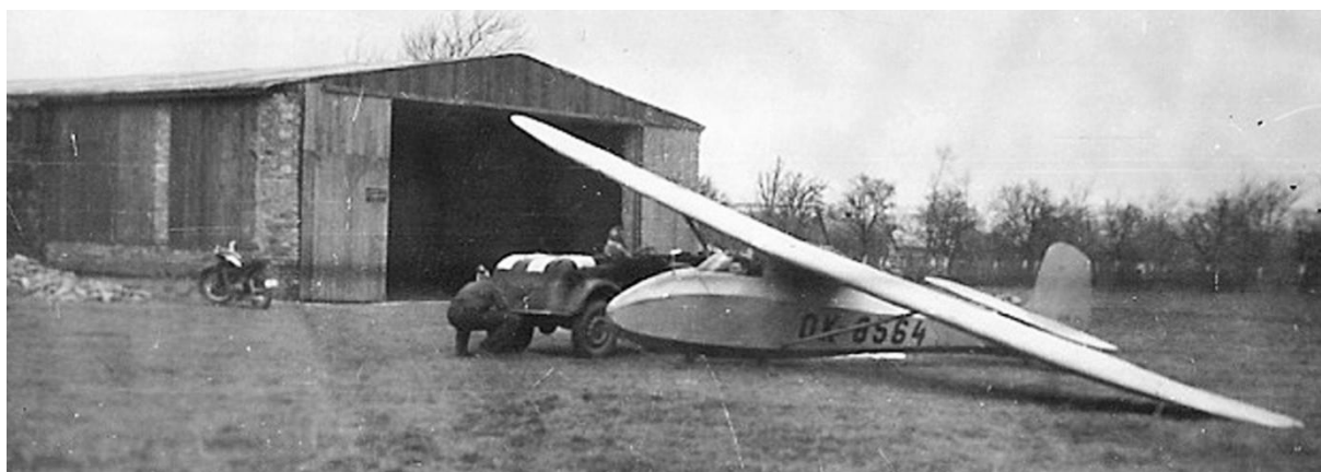
Zlín Z-24 Krajánek OK-8564 a automobil ILO-Tempo (řечený „Kýbl“) sloužící ke zpětnému transportu navijákového lana; Nový Dvůr, jaro 1950
